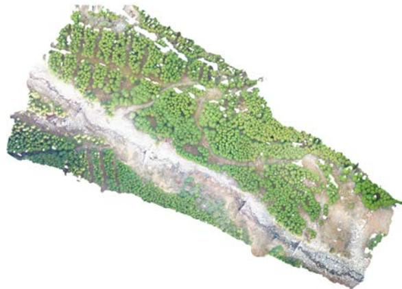
図 4.2 斜面崩壊地オルソ画像（市房ダム上流湯山川、Y-5 地点他）
