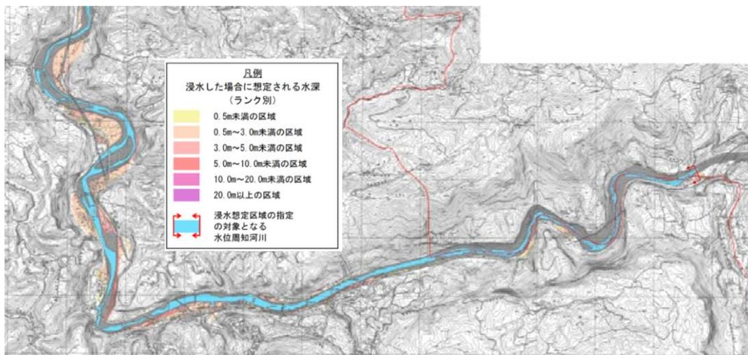
図 8.17 玖珠川洪水浸水想定区域図(計画規模)
