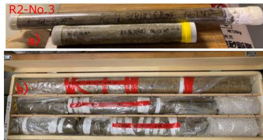
写真 5.3 a)：筑後川 39k720 地点で採取した Bcs 層と As 層試料, b)：球磨川 左岸 55k で採取された旧堤体土と置き換え土
