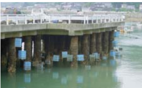
生育実験中のマガキ。写真のように水没する時間を変えて、成長(富栄養化物質除去量)を比較した。
