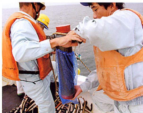
定点で潜水により亂れの無い堆積物を採取して、攪拌の前後の変化を調べる。
