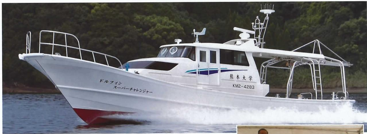
↑船体：纖維強化プラスチック、全長（登録長）：16.60m（14.16m）、全幅（登録幅）：3.80m（3.48 m）、全深（登録深）：1.69m（1.01m）、総トン数：9.7トン、主機関：ディーゼル1機1軸、推進装置：固定ピッチ3翼プロペラ、連続定格出力/回転数：423キロワット（575馬力）/2,048毎分回転、燃料：軽油（1,700L）、巡航速度：22.5ノット、スラスター：2台（船首・船尾）、旋回径：3.5挺身以下、定位保持：半径3m以内、定員：30名
