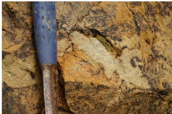
崩壊面には風化した砂岩が露出
